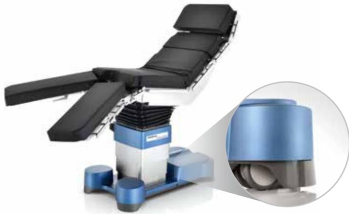
*Diseño de freno centralizado activado eléctricamente con 4 ruedas dobles de 100 mm de diámetro que permite facilitar el movimiento, con subida y bajada automática de tal manera que la base toca el suelo con gran fuerza de fricción evitando el movimiento de la mesa.*
