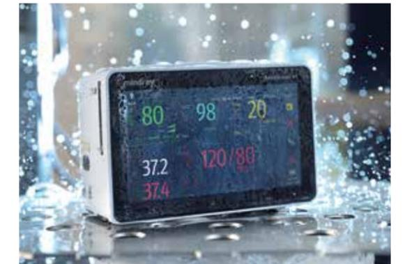
El diseño robusto del N1 ofrece protección de grado IP44 al agua y al polvo, así como una resistencia a caídas desde 1,2 m en cada una de las seis superficies del dispositivo, lo que elimina las preocupaciones en torno a las salpicaduras de líquidos y a los daños accidentales provocados por caídas durante el transporte.
